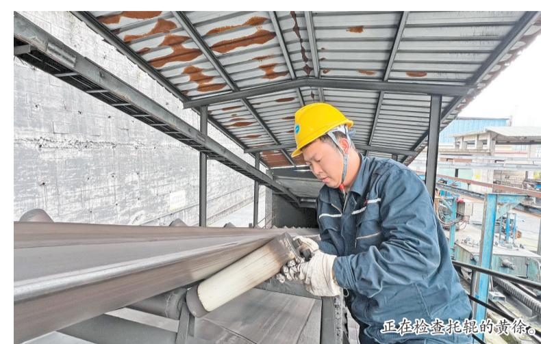
正在检查托辊的黄徐。
